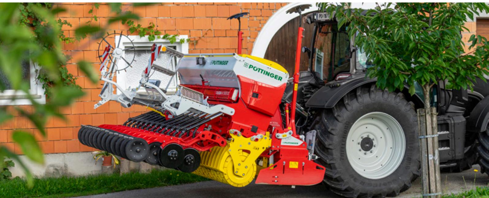
Las gradas rotativas rígidas van divididas en tres diferentes líneas de modelos. La diferencia más grande está sobre todo en el dimensionamiento de los elementos de las diferentes variantes de grupo, que van concebidas para los diferentes rendimientos de los tractores. Todo une las posibilidades de ajuste para conseguir un perfecto resultado de trabajo.
